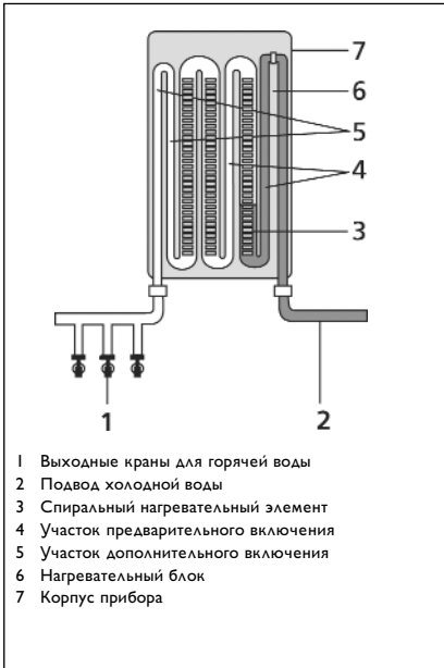
Принципиальная схема нагревательной системы с неизолированной спиралью моделей DHE, DHB.
